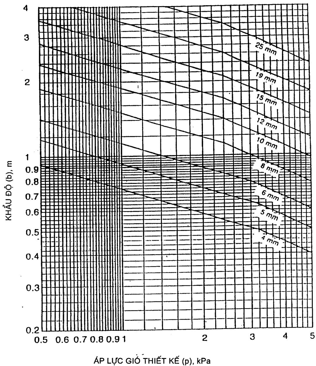
**Hình C.4 - Khẩu độ cho tấm kính tối (làm từ kính nỗi) có hình chữ nhật, chiều dày danh nghĩa tiêu chuẩn, chỉ có khung ở hai cạnh đối diện và hình chữ nhật có tỷ số cạnh cao có khung đỡ tất cả các cạnh**
