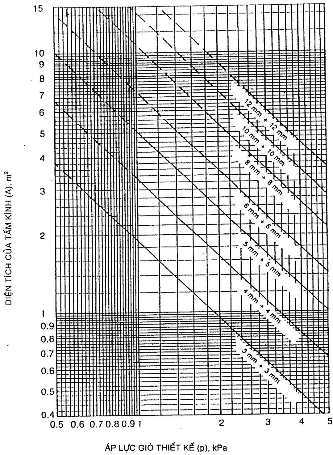
Hình C.7 - Kính thước của tấm kính ủ thường (từ kính nỗi) có hình chữ nhật, chiều dày danh nghĩa tiêu chuẩn, được sử dụng trong bộ của cách nhiệt (hai lớp) có khung đỡ các cạnh
