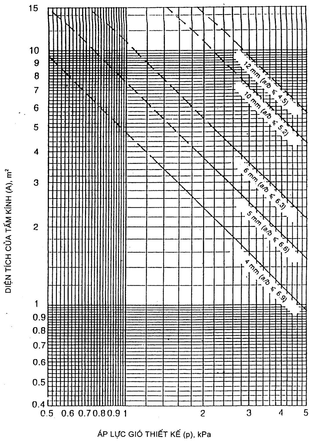
**Hình C.12 - Kích thước của tấm kính cán tông nhiệt hình chữ nhật, chiều dày danh nghĩa tiêu chuẩn, có khung đỡ tất cả các cạnh và tỷ số các cạnh nhỏ hơn hoặc bằng giá trị đã cho**
