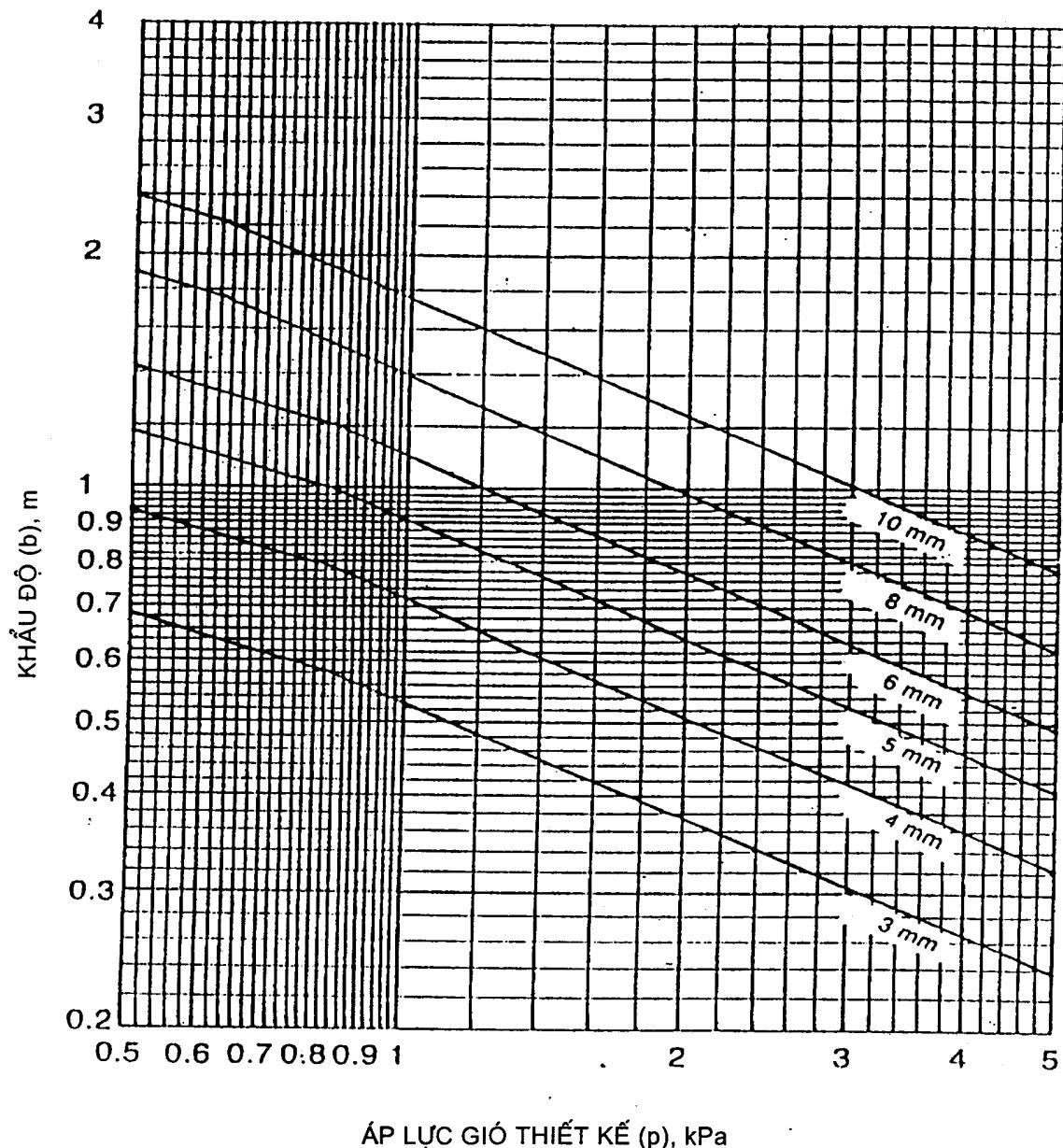
**Hình C.6 - Khẩu độ cho tấm kính bán tối (từ kính nổi) hình chữ nhật, chiều dày danh nghĩa tiêu chuẩn, chỉ có khung ở hai cạnh đối diện và hình chữ nhật có tỷ số cạnh cao có khung đỡ tất cả các cạnh**
