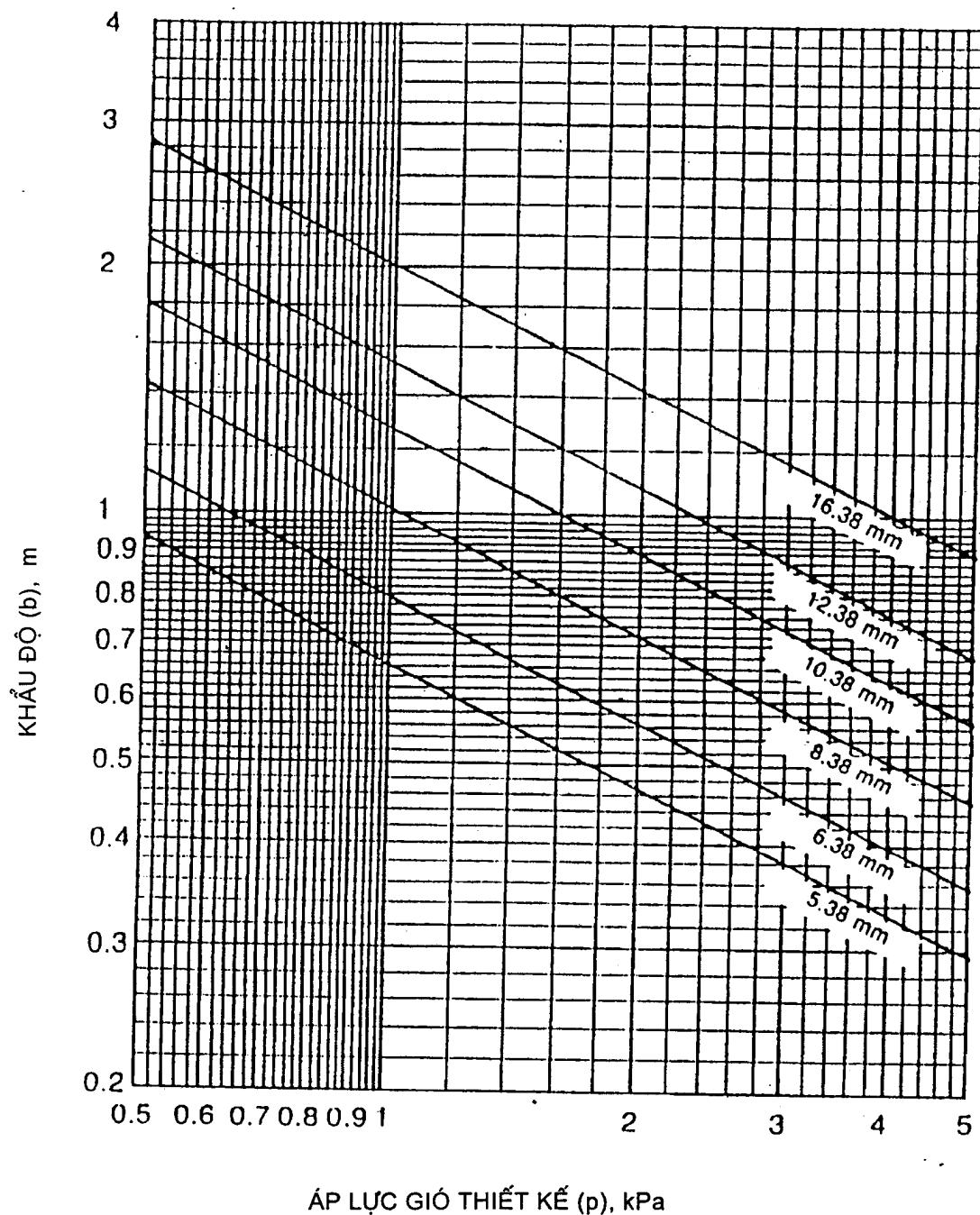
**Hình C.9 - Khẩu độ cho tấm kính dán hình chữ nhật (từ kính nồi ủ thường)
