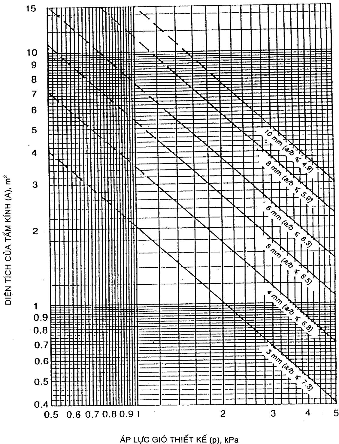
**Hình C.5 - Kích thước của tấm kính bán tối (từ kính nỗi) hình chữ nhật, chiều dày tiêu chuẩn, có khung đỡ tất cả các cạnh và tỷ số cạnh nhỏ hơn hoặc bằng giá trị đã cho**
