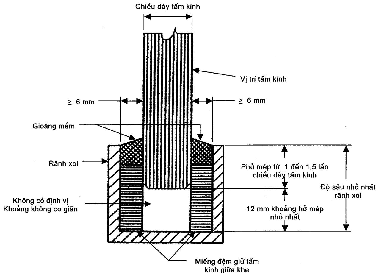
Hình 7 - Kết cấu khung kính cho lắp đặt kính tông tóp kiểu treo
