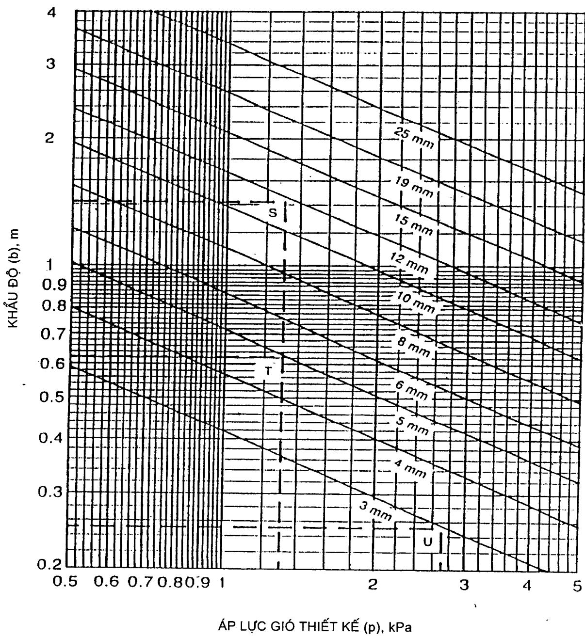
**Hình 3 - Biểu đồ khẩu độ của tấm kính nổ ủ thường, hình chữ nhật, chiều dày tiêu chuẩn, chỉ có khung đỡ ở hai cạnh đối diện và của hình chữ nhật có tỷ số cạnh cao và có khung đỡ ở tất cả các cạnh**
