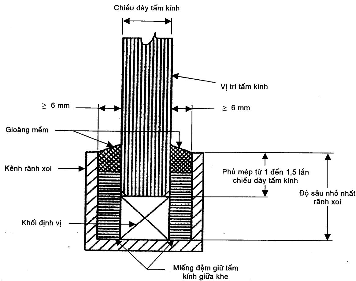
Hình 8 - Kết cấu khung kính cho lắp đặt kính tông kiếu đỡ
