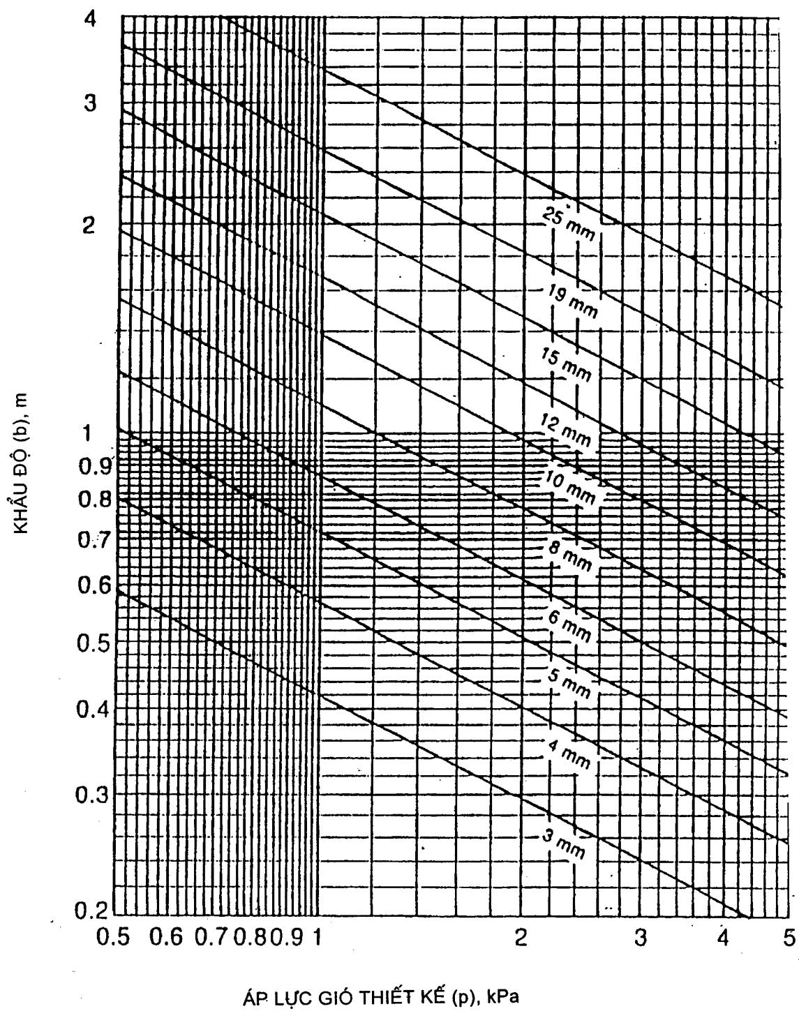
Hình C.2 - Khẩu độ của tấm kính ủ thường (kinh nỗi) hình chữ nhật, chiều dày tiêu chuẩn, chỉ có khung đỡ ở hai cạnh đối diện và hình chữ nhật có tỷ số cạnh cao có khung đỡ tất cả các cạnh
