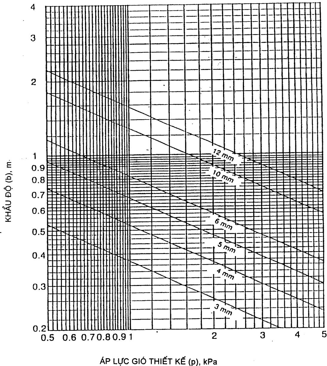
**Hình C.11 - Kích thước của tấm kính cản ủ thường hình chữ nhật, chiều dày danh nghĩa tiêu chuẩn, có khung đỡ hai cạnh đối diện và cho hình chữ nhật có tỷ số cạnh cao, có khung đỡ tất cả các cạnh**
