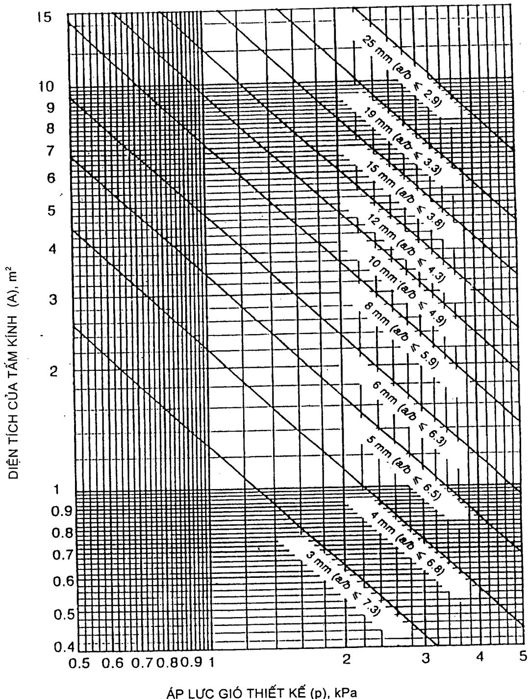
Hình C.1 - Kích thước của tấm kính ủ thường hình chữ nhật, chiều dày tiêu chuẩn với tỷ số
