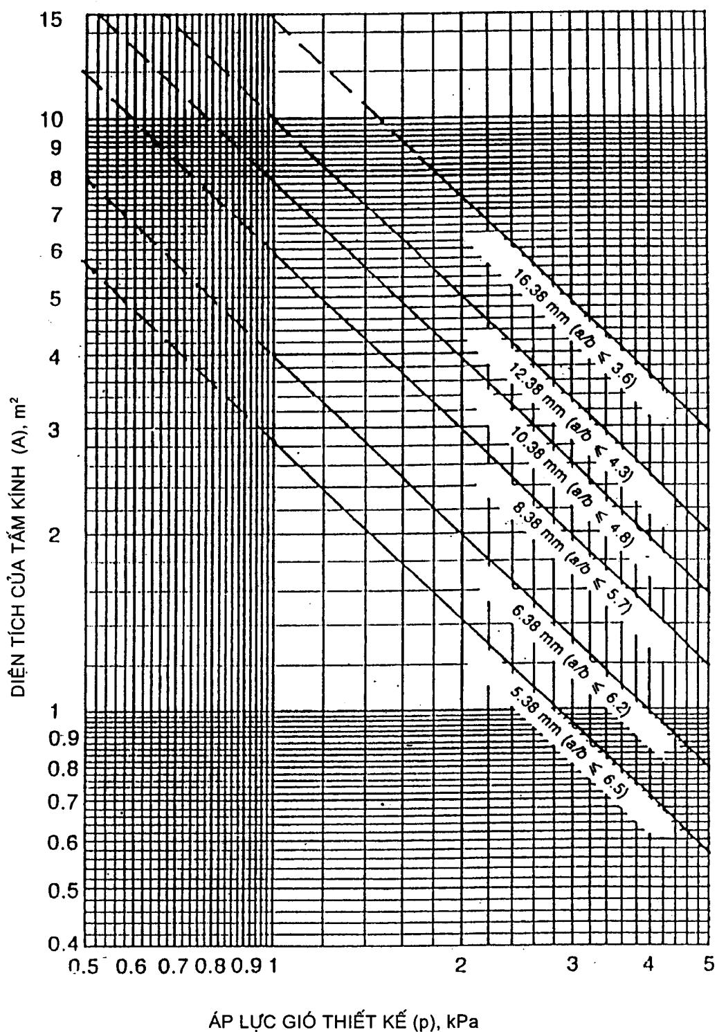
Hình C.8 - Kích thước của tấm kính dán (từ kính nỗi ủ thường) có hình chữ nhật, chiều dày danh nghĩa tiêu chuẩn, có khung đỡ tất cả các cạnh và tỷ số cạnh nhỏ hơn hoặc bằng giá trị đã cho
