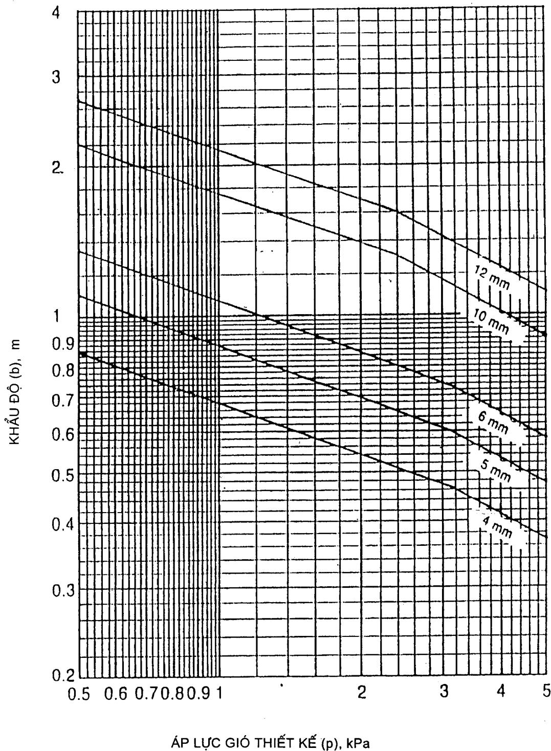
Hình C.13 – Khẩu độ của tấm kính cán tông nhiệt hình chữ nhật, chiều dày danh nghĩa tiêu chuẩn có khung đỡ hai cạnh đối diện và cho hình chữ nhật có tỷ số các cạnh cao, có khung đỡ tất cả các cạnh
